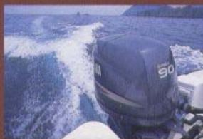
4ストローク90馬力のエンジンの最高速度は25ノットをゆうに超える
